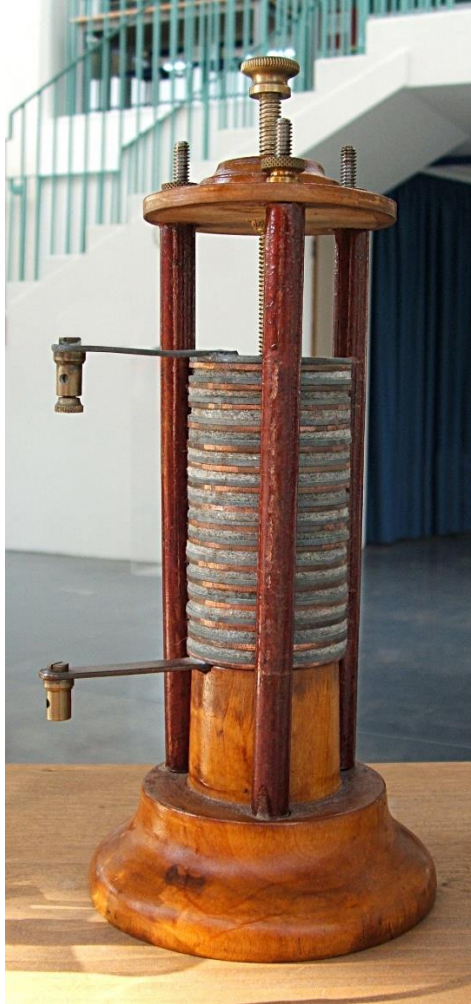
Une réplique de la pile électrique de Volta – © Wikipedia
